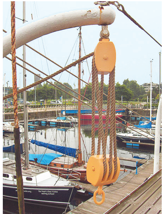
Рис. 3. Шлюпбалка с полиспастом для спуска на воду и подъема шлюпок на борт
