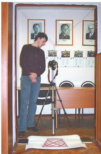
Рис. 4. Двухчастотный маятник, снабженный лазерной указкой
